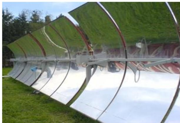
**Figura 4.** Concentrador cilíndrico.
