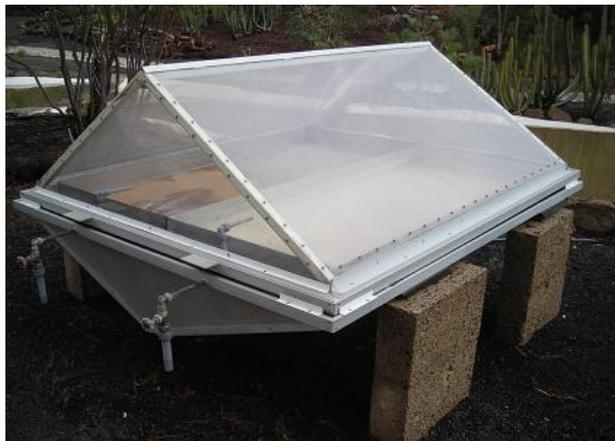
**Figura 1.** Destilador solar para potabilización de agua.
