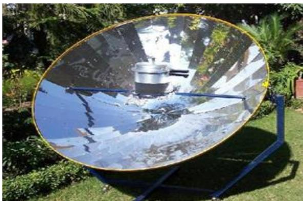
**Figura 5.** Concentrador parabólico.
