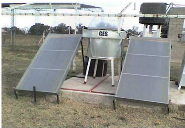
**Figura 2.** Destilador con acumulador de energía.
