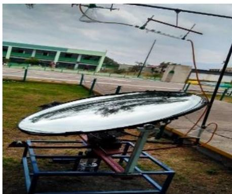
**Figura 14.** Construcción del destilador solar.
